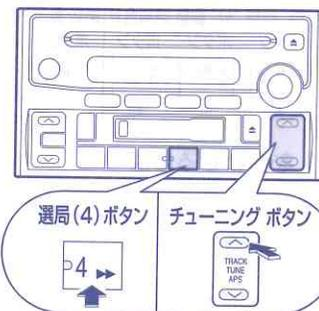
エンジン スイッチを“ACC”にし、本機の電源を“OFF”にします。選局 (4) ボタンを押しながら、チューニング ボタンの△側を押します。時計表示に戻すときは、再度同じ操作を繰り返します。
