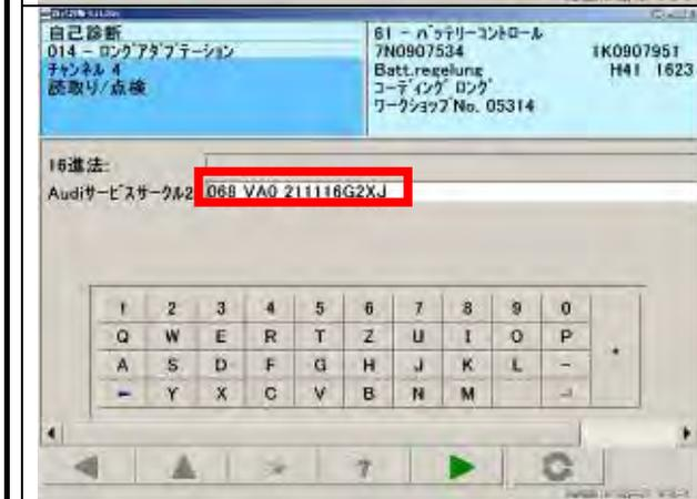
新たに装着したバッテリーの情報 (Ah、サブライヤー、ロットナンバー)を入力する。
