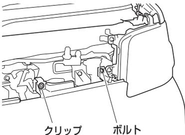
3. バンパーを車両前側に引いてツメを外し、上部を浮かせます。
